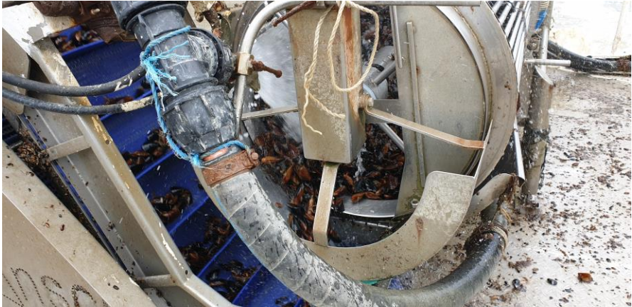
Fig. 19. Mașină de spălare - triere midii: cilindrul de spălare, ferma Black Sea Shells, Kavarna, Bulgaria (foto original Magda Nenciu) .
